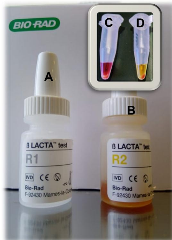
Figura 9. Kit \beta LACTA™ test. Se muestran los reactivos R1 (A) y R2 (B) que conforman el kit, además de C y D, los cuales son resultados positivo y negativo, respectivamente a la detección de enterobacterias BLEEs
