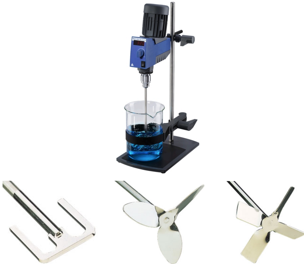
Figura 4-3. Agitador de propela y diversos tipos de propela. Agitador de propela (arriba), propela de ancla (abajo, izquierda), propela marina (abajo, centro) y propela de cruz (abajo, derecha).
