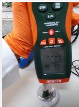
Figura 16. Medición de Humedad relativa dentro de la cápsula.
