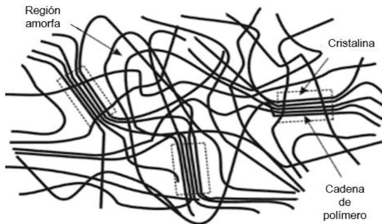
Figura 11. Región cristalina y amorfa de la estructura polimérica del polietileno (PE)
