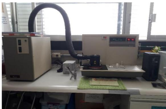
Figura 20. Calorímetro diferencial de barrido modulado (MDSC).
