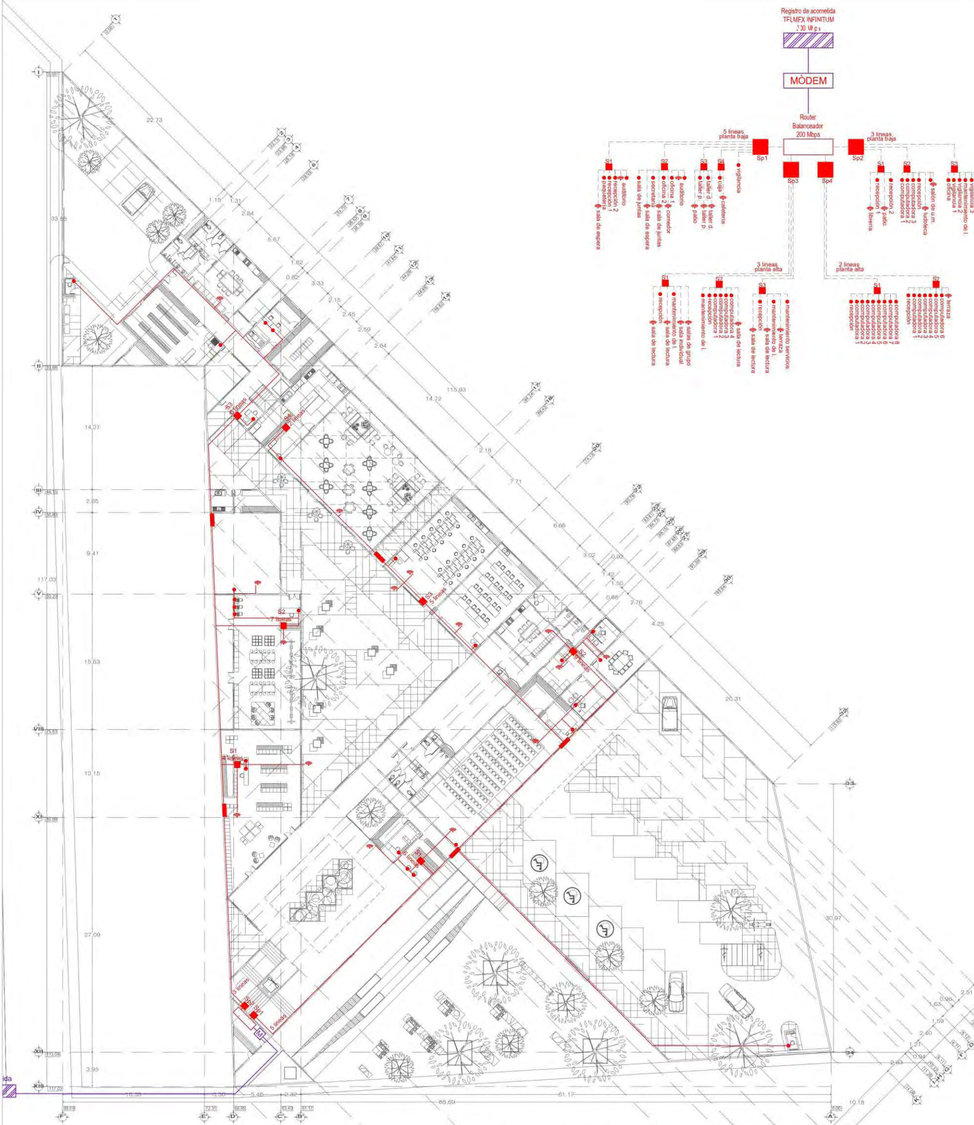
INSTALACIÓN DE INTERNET planta baja escala 1:200
