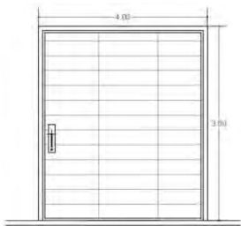
P13 Puerta corrediza de aluminio forrada con placas de madera, con manija simple Modelo: Ministerio, en bronce patill
