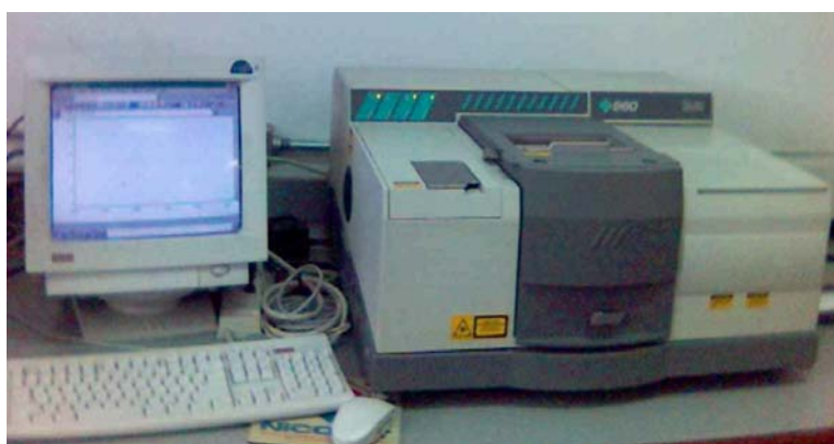
Figura 26. (a) Equipo de Infrarrojo marca NICOLET Magna-560, (b) Colocación del porta-muestra en el espectrofotómetro de IR
