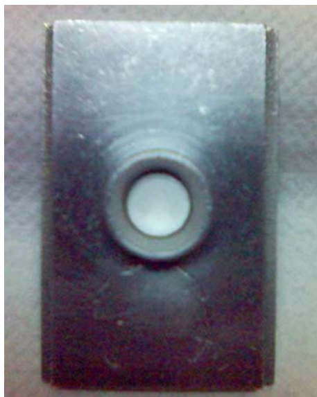
Figura 25. Pastilla de KBr en el porta-muestra
