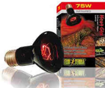
Fig.8. Esta bombilla emite ondas de calor infrarrojas lo cual la convierte en una lámpara de calentamiento típica. La lámpara tiene un reflector especial incorporado para enfocar el calor en cualquier dirección. El vidrio rojo transmite ondas infrarrojas producidas por un filamento especial de la bombilla. La luz rojiza no interfiere con la actividad normal durante la noche o el día, lo cual lo convierte en una excelente fuente de calor. Tiene un costo aprox. de \$ 200.00 M.N.
