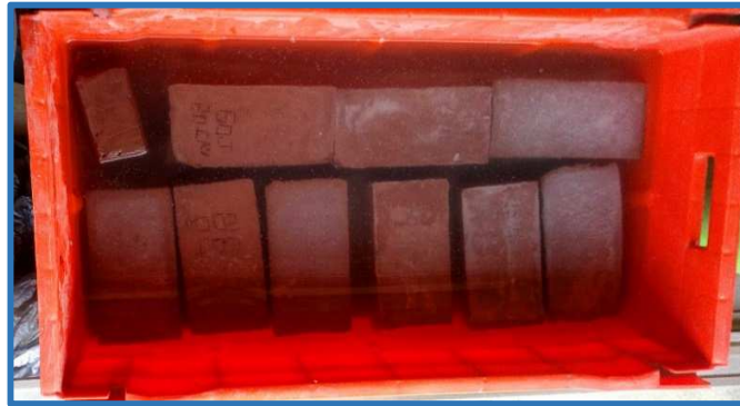
Figura 4.8 Ladrillos en el proceso de curado
