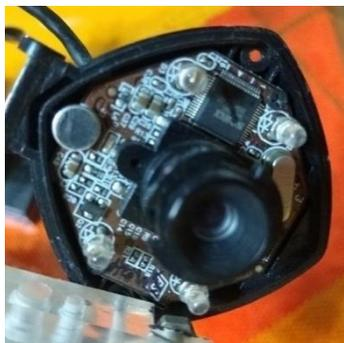
Ilustración 46. Webcam de visión nocturna infrarroja. (agosto 2019) Ilustración propia del autor.
