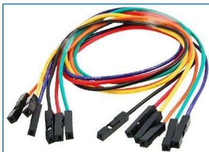
Ilustración 48. (Consultada Julio 2019) 'Jumper Hembra-Hembra de 20 cm'. Ilustración obtenida del sitio web: <http://www.voltix.com.mx/opencvoltix/JUM-HH20>
