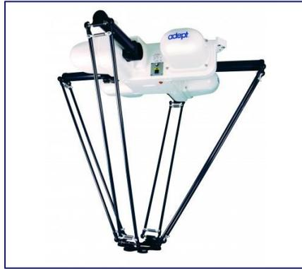
Ilustración 16. Robot paralelo Adept Quattro (Consultada agosto 2019) Ilustración obtenida de: <https://info.vinssa.com/robot-paralelo-adept-quattro-eplc800h>
