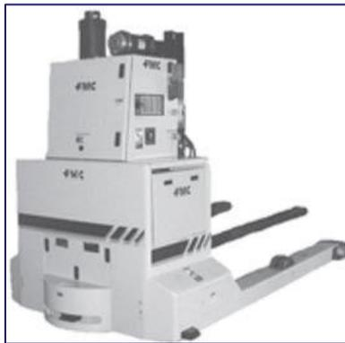
Ilustración 14. Un AGV autónomo. Ilustración obtenida del libro: *Introducción a la Robótica*. Kumar, S.
