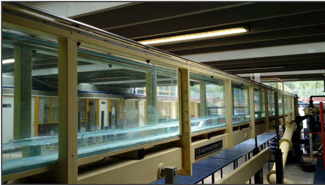
Figura 2.1. Canal PLINT del Laboratorio de Hidráulica de la Facultad de Ingeniería de la UNAM.
