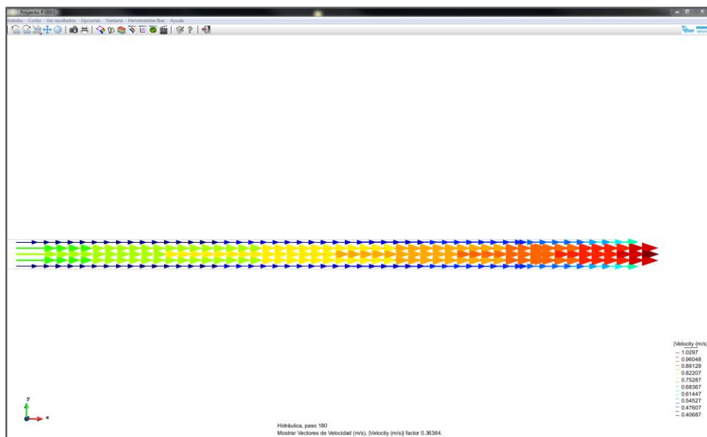
Figura 4.29b. Visualización de la velocidad presentada por medio de vectores y un espectro de colores en el modelo del perfil N° 1.
