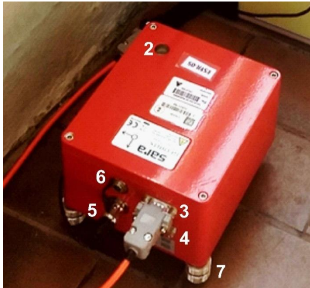
Figura 4.29 Vista del sismómetro marca SARA y sus componentes
