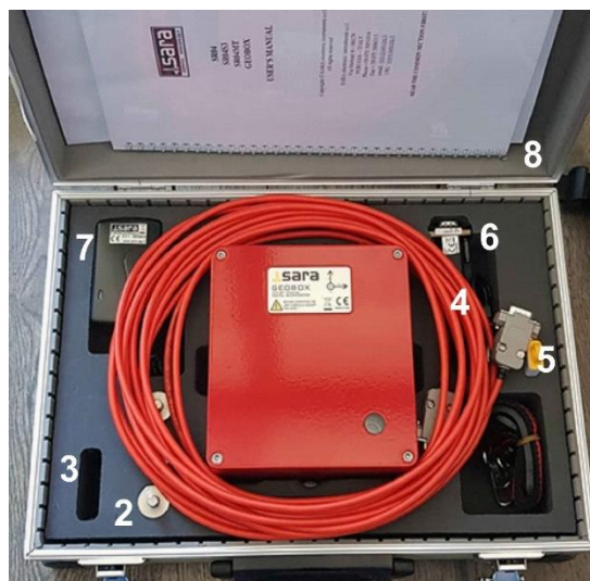
Figura 4.28 Maletín del equipo GEOBOX con sus componentes.
