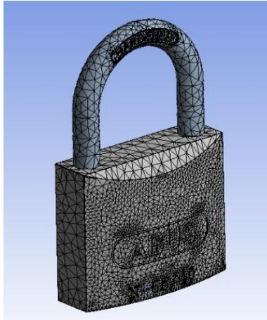
**Figura 24** Discretización de un cuerpo en elementos regulares para el método de elemento finito
