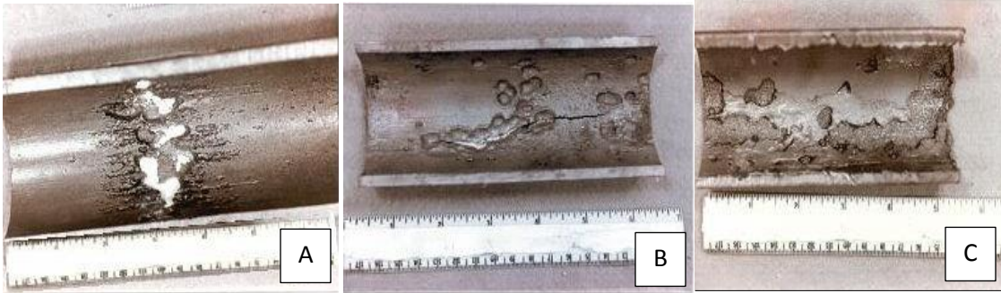
Figura 3. 11 A) “Ring Worm Corrosion” tipo de corrosión por CO 2 caracterizada por la formación de agujeros en las paredes de la tubería, B) Corrosión por CO 2 caracterizada por la formación de picaduras interconectadas y C) “Mesa Corrosion”, tipo de corrosión por CO 2
