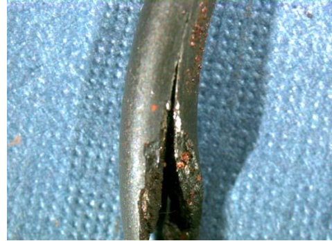
Figura 3. 14 Agrietamiento por esfuerzo de sulfuro (SSC).
