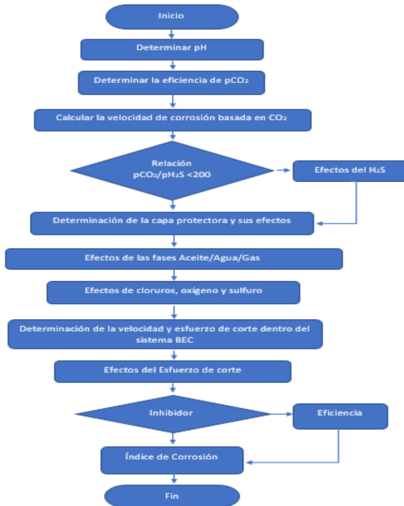
Figura 5. 20 Diagrama del proceso de obtención de resultados para el intervalo que abarca la bomba BEC
