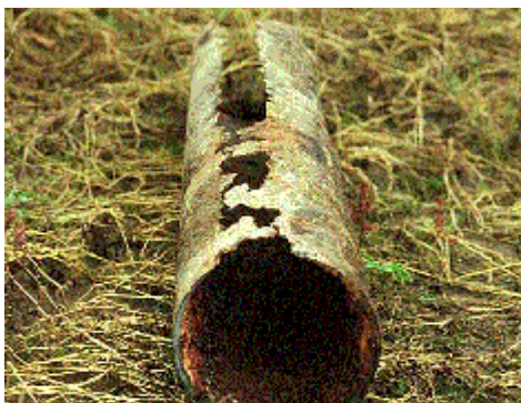
Figura 3. 13 Figura 3.13. Corrosión por H_2S en Varillas de bombeo
