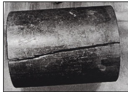
Figura 3. 15 Agrietamiento inducido por hidrogeno (HIC)
