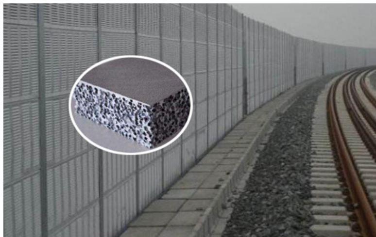
Figura 1.10 Panel de espuma de Al empleado para disipación de sonido [30].
