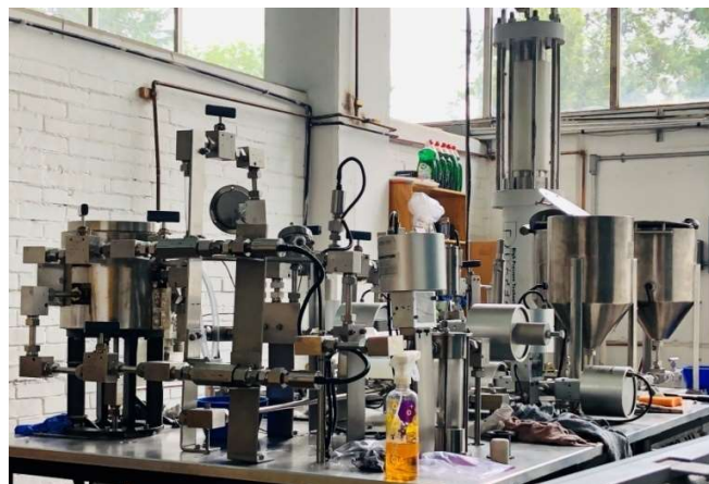
Figura 2.14 Poro-permeámetro empleado para realizar los ensayos de permeabilidad.
