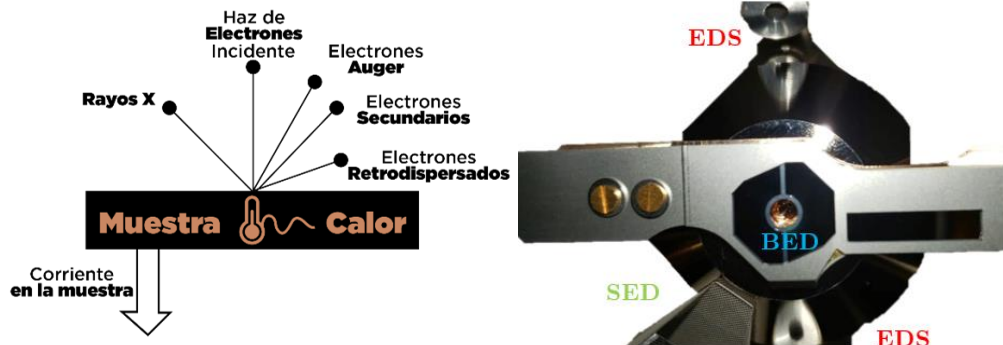
Figura 16 Detectores en cámara de observación
