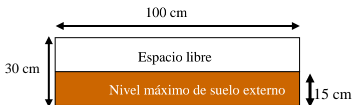
Figura 27. Profundidad a la que se recomienda enterrar la caja de pupación.
