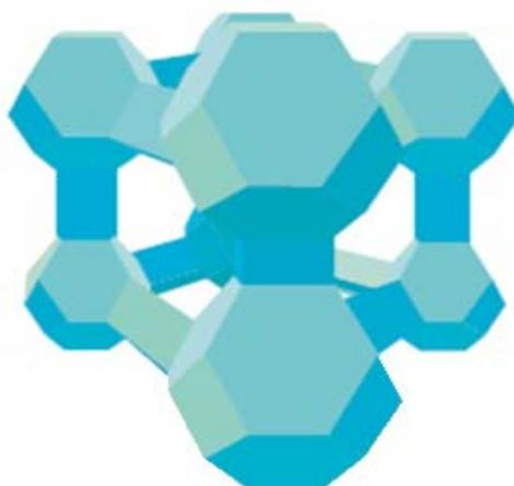
**Fig. 8. Estructura de la Zeolita A.**
