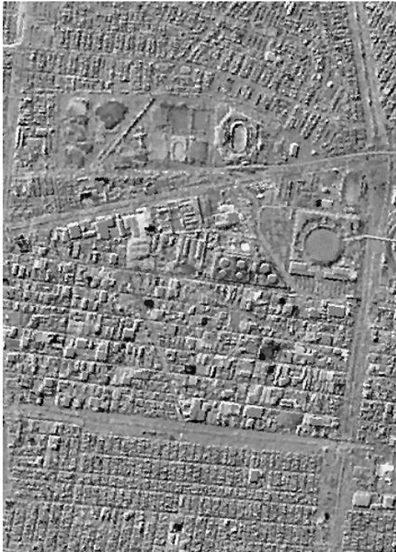
(e) Imagen Textura Relieve de Spot-5, procesada con la Componente Principal Dos Cp^2 , con 5m/pixel de resolución espacial.
