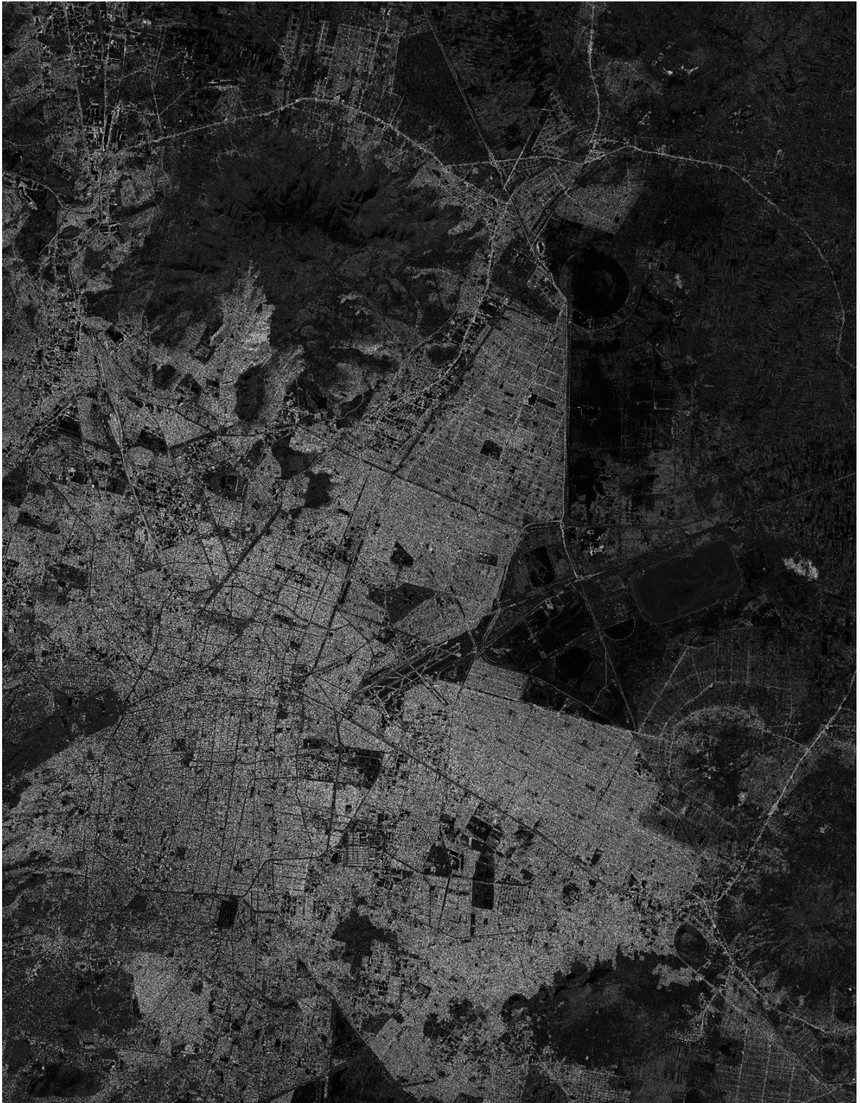
Figura 3.2: Imagen Spot 5 de Textura-Rugosidad obtenida con el Operador de Divergencia, 10m/pixel de resolución espacial. Fuente: elaboración propia y procesamiento.
