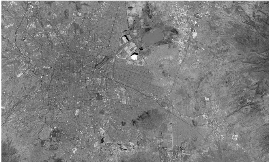
Figura 2.6: Imagen del sensor Terra/Aster de la región espectral ASTER VNIR Band 3B (0.8040) de la Ciudad de México. Fuente: Elaboración propia y procesamiento.
