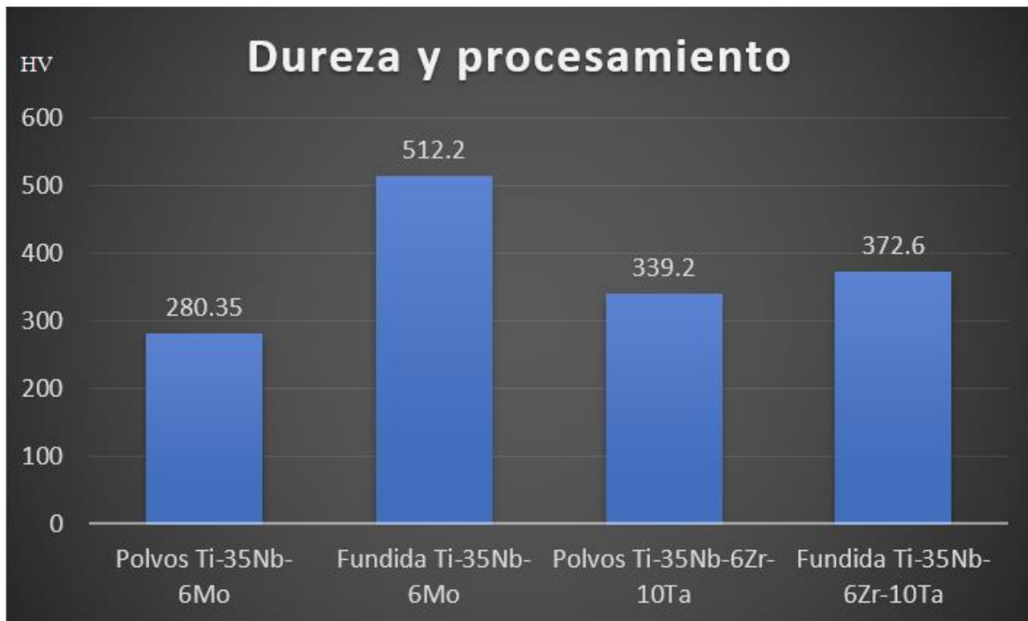
Figura 4.17 Comparación de durezas obtenidas por composición y procesamiento.
