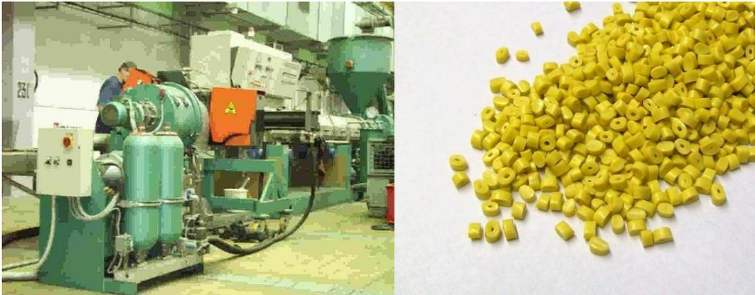
Figura 10. Peletizadora y producto final (pellet's).
