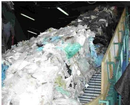
Figura 5. Cintas transportadoras con material a reciclar.
