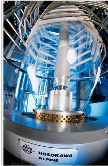
Figura 11. Película de globo en la extrusora.
