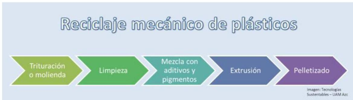
Figura 4. Diagrama que ilustra el reciclaje mecánico del plástico.
