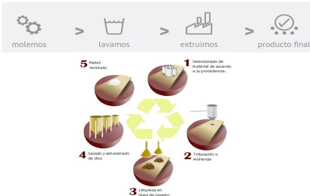
Figura 3. Pasos para el reciclaje de polietileno.
