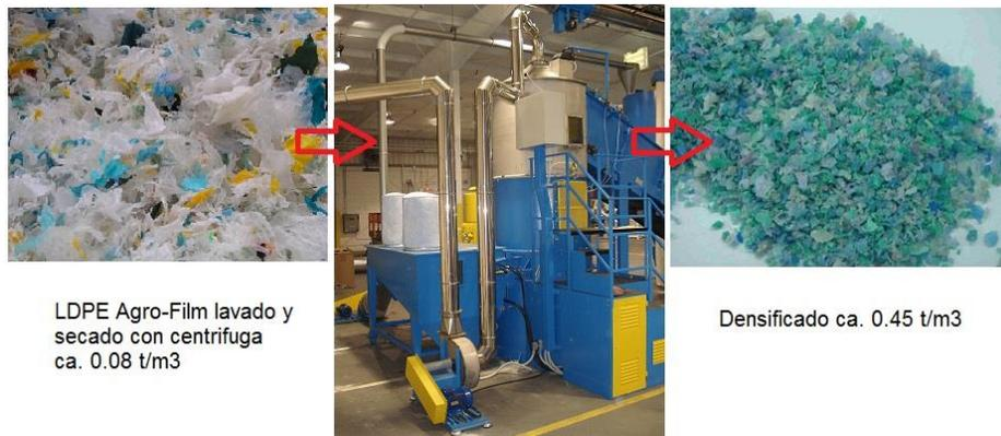
Figura 9. Comparación del material, antes y después del densificado.
