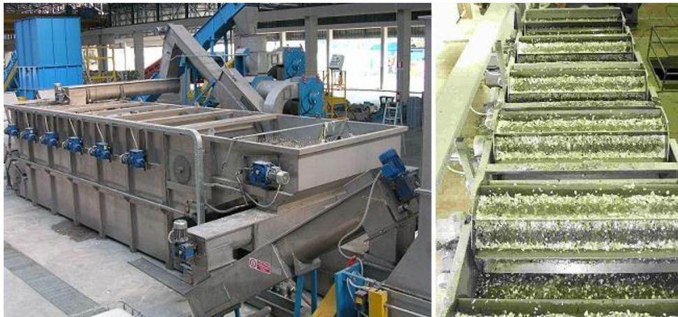
Figura 7. Limpieza de material picado.
