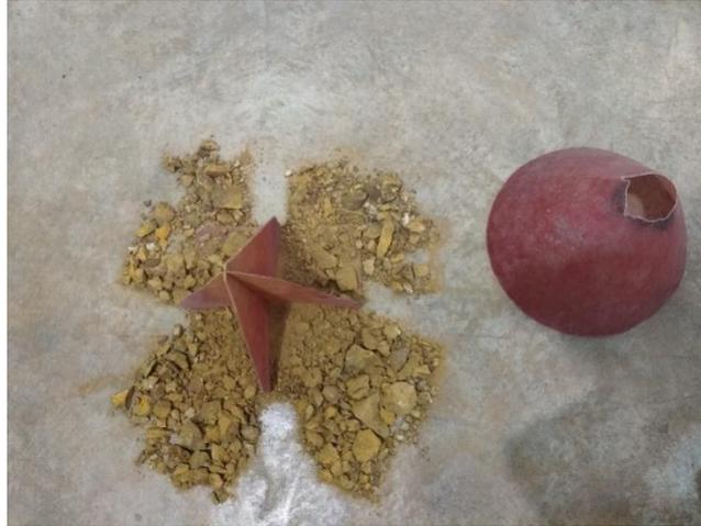
Figura 11. Homogeneizado y cuarteo del mineral empleando el método de cono-cuardeo.
