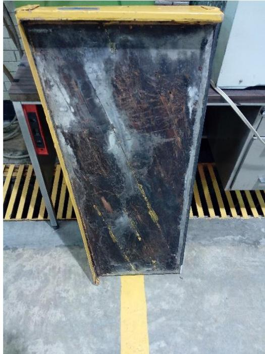
Figura 16. Madera dañada por humedad
