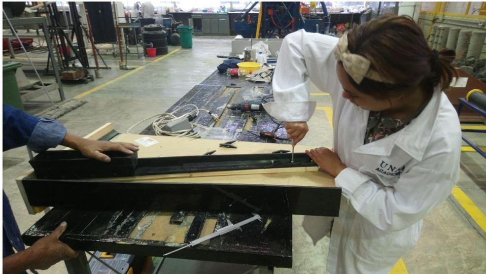
Figura 17.3 Construcción de mesa concentradora
