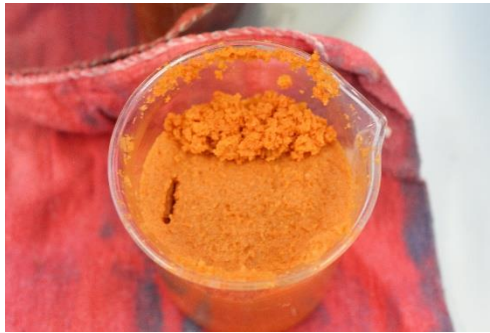
Figura 40. “Levantamiento” en la zona izquierda de la muestra, debido a la evaporación de agua por la variada distribución de energía dentro del horno.
