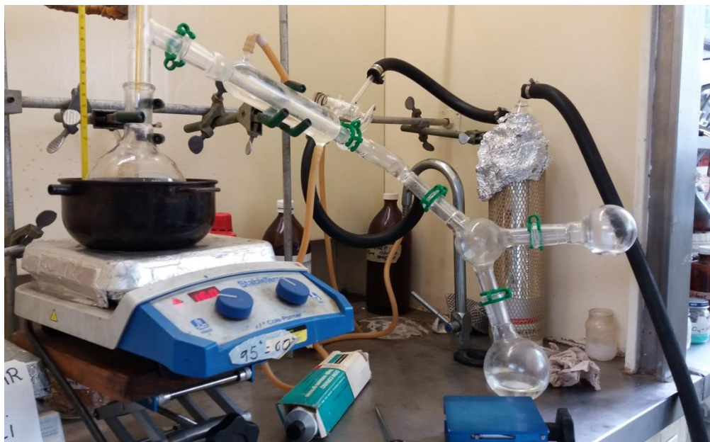
Figura 13. Montaje de sistema de destilación a presión reducida.
