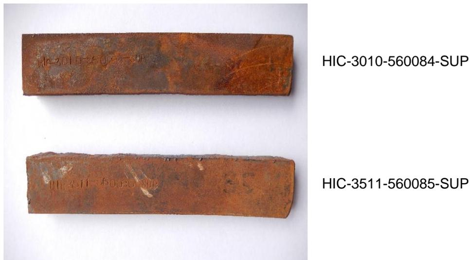
**Figura 4.1.** Placas de acero de llegada utilizadas en este trabajo de investigación.
