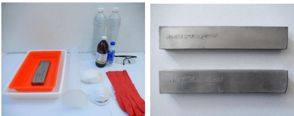
Figura 4.4. Decapado de las placas de acuerdo a la norma ASTM G1-03 (2017).
