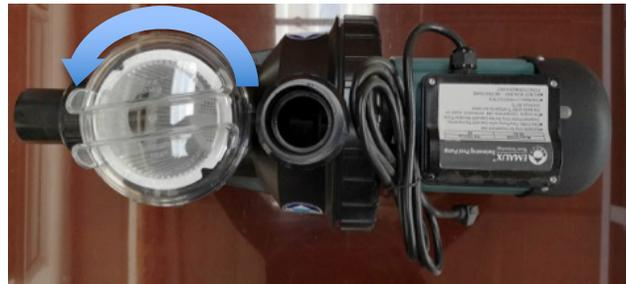
Imagen 25. Sentido de giro para tapa de trampa de cabellos para equipo de 1/2Hp. Fuente fotográfica: Elaboración propia.
