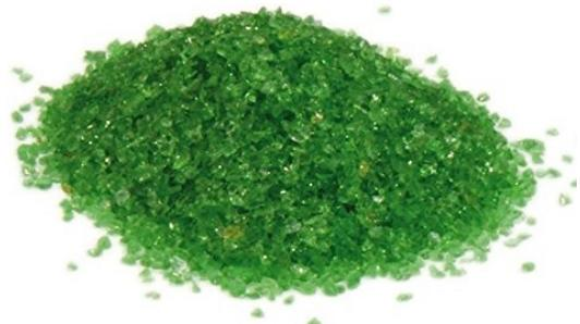
Imagen 48. Vidrio filtrante, es una alternativa de gran aceptación como material para filtros. Fuente fotográfica: [imagen tomada de drydenaqua.com](http://imagen tomada de drydenaqua.com)
