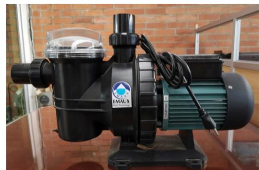
Imagen 24. Equipo hidroneumático de 1/2 Hp para filtración. Fuente fotográfica: Elaboración propia.
