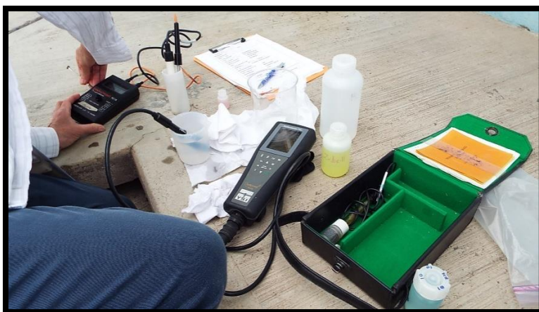
Figura 8. Medición de parámetros fisicoquímicos en campo.
