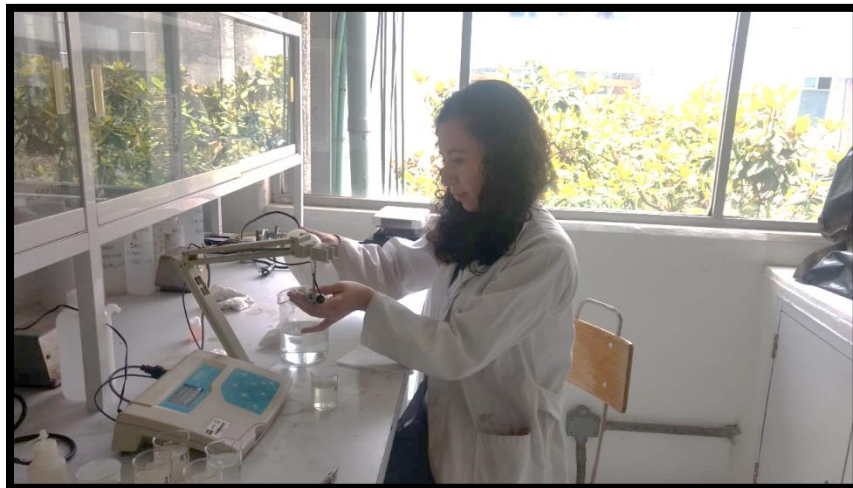
Figura 9. Titulación química para determinar calcio y magnesio en el agua subterránea y determinación de parámetros fisicoquímicos.
