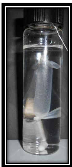
Figura 22. Modelo de bolsas de diálisis utilizado para la disolución.
