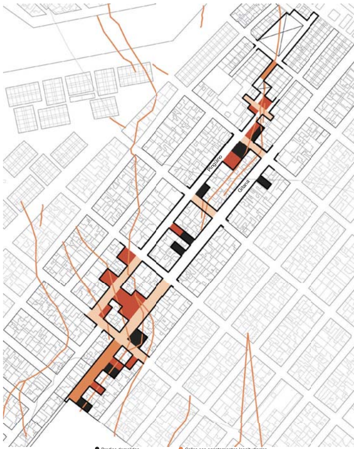
Esc 1 : 2.000 0 20 m 40 m ● Predios demolidos ● Predios con daño estructural ● Cales con agrietamientos longitudinales ● Cales con agrietamientos transversales ● Grietas Fig. 81 Condición actual de daños.
