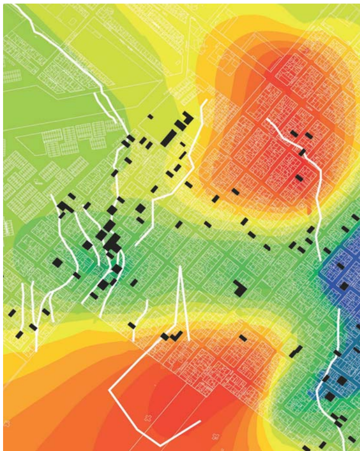
Fig. 23 Nivel freático y hundimientos en la colonia Del Mar.
