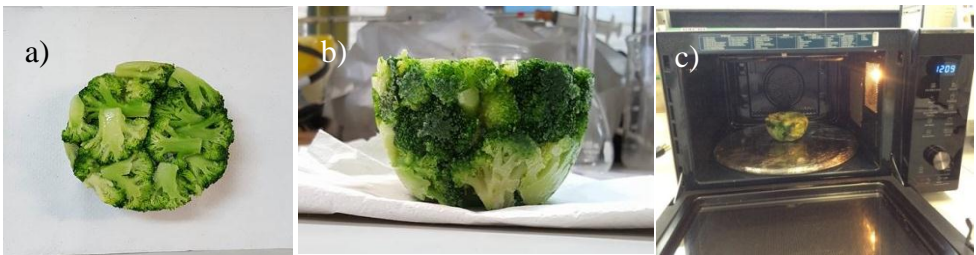
Figura 19a) vista de planta de muestra. 19b) vista de elevación de muestra. 19c) calentamiento de muestra para validación de simulación
