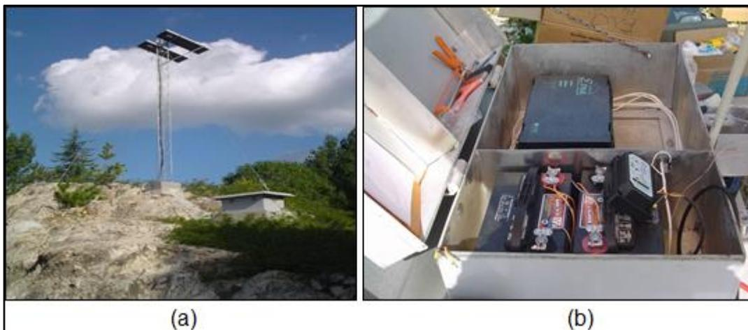
Figura 22. a) Estación acelerográfica de campo libre.
