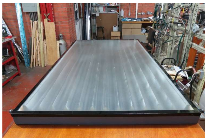
Ilustración 3.9 Colector parabólico compuesto. Instituto de Energías Renovables, UNAM
