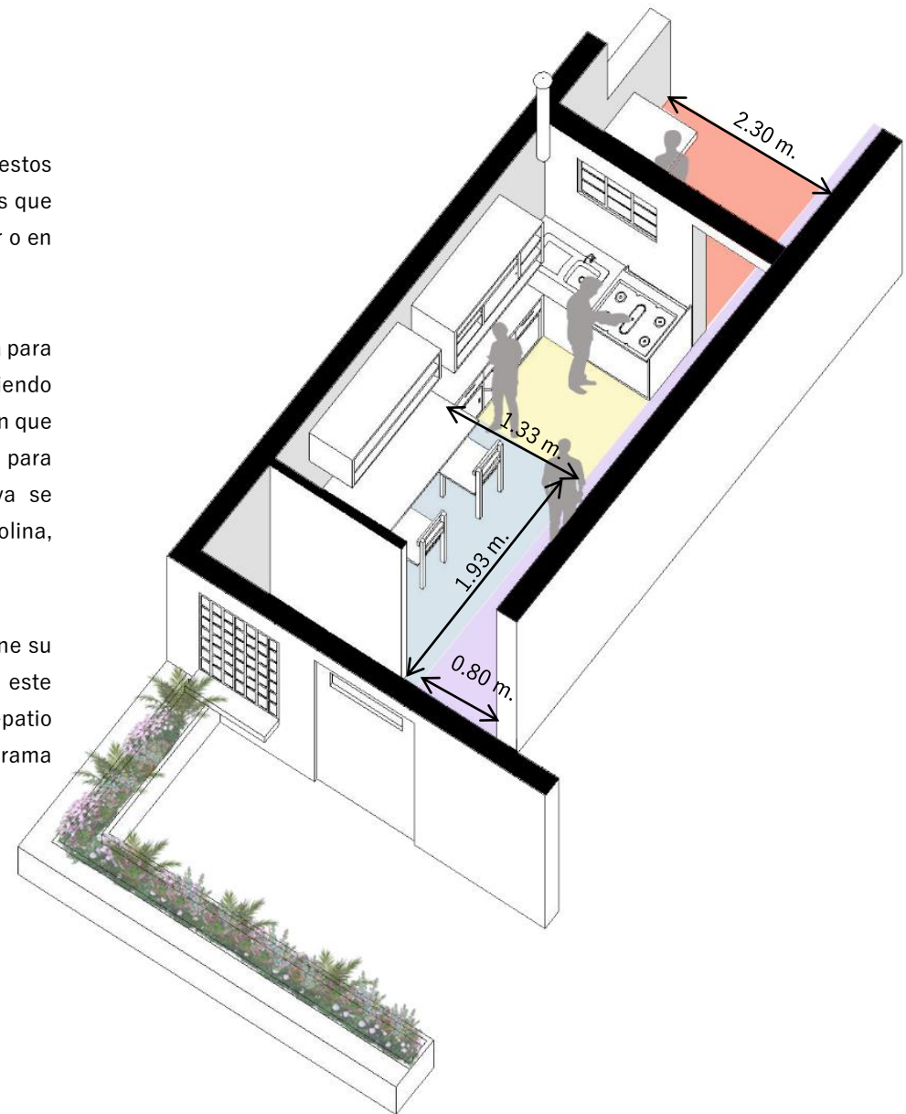
Isométrico, detalle de los espacios de cocina, comedor y patio de servicio o azotehuela, vivienda tipo 1, casa mínima obrera, Juan Legarreta, 1933, Fuente: Propio 2019
