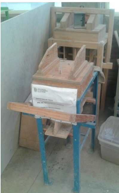
Figura 8. Máquina artesanal de ladrillos
