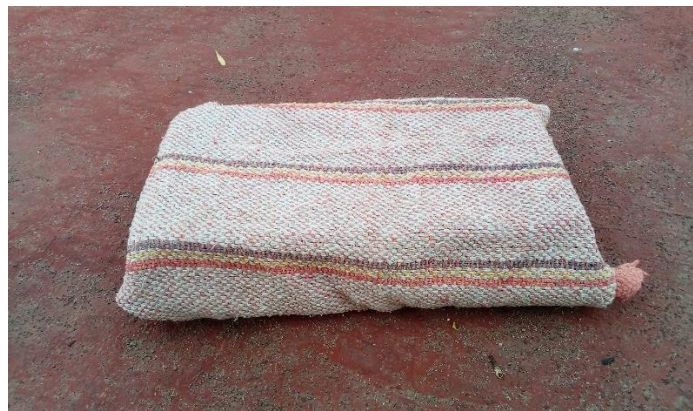
Figura 26. Secado superficial del ladrillo
