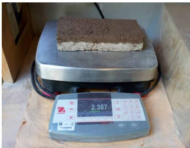
Figura 24. Peso húmedo del ladrillo
