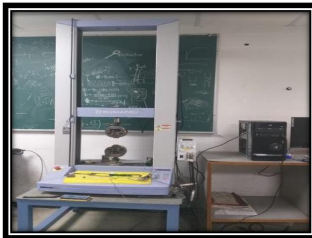
Figura 3.18 Maquina Shimadzu Model AGS-X para pruebas de tracción.
