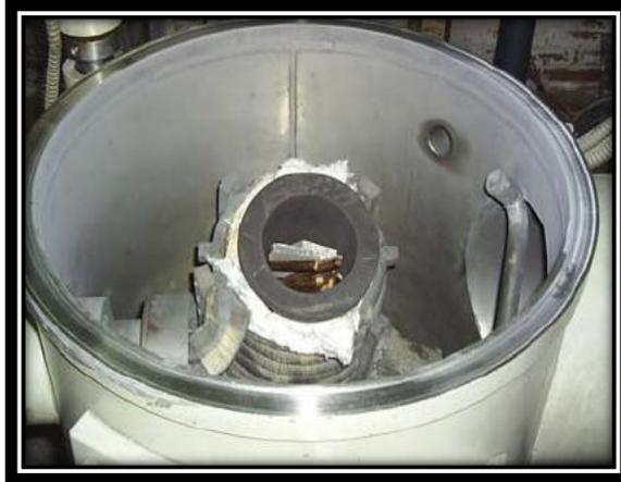
Figura 2.2 Campana de vacío del Horno de Inducción y crisol.
