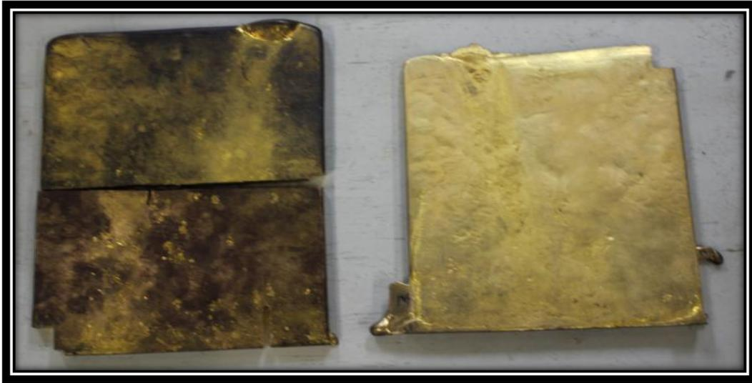
Figura 2.4 Lingotes en fase Austenita y Martensita obtenidas posterior a la fundición.
