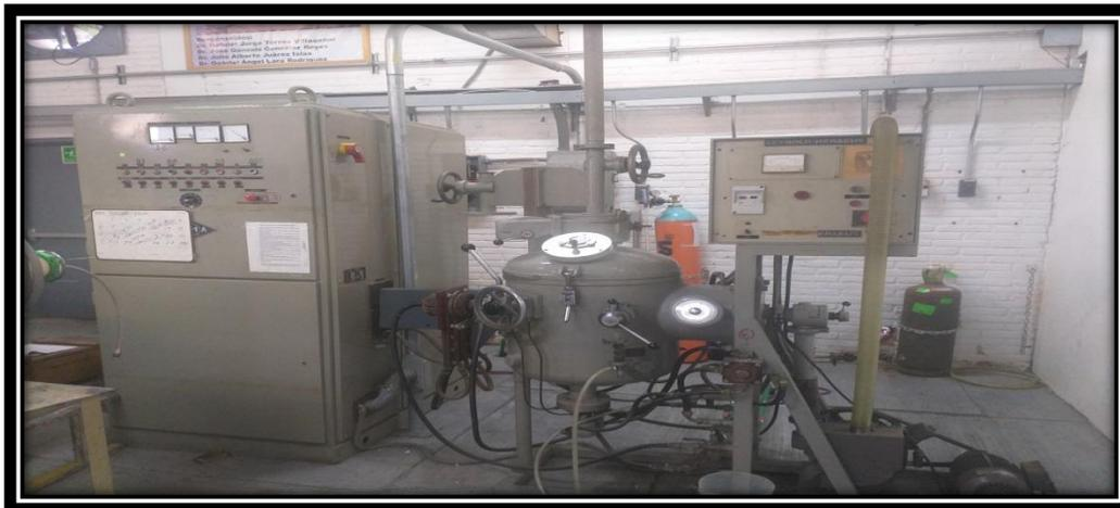
Figura 2.3 Horno de radio- frecuencia y lingotera usada para las aleaciones.
