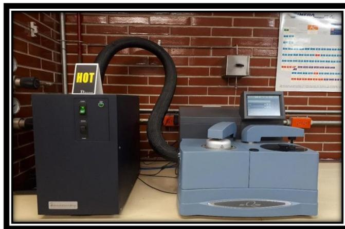
Figura 2.12 Equipo de calorimetría diferencial de barrido.
