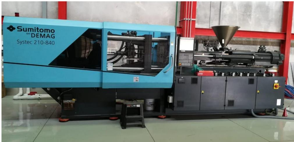
Figura 17 Máquina de inyección Sumitomo Shi Demag 210 -840<sup>25</sup>.
