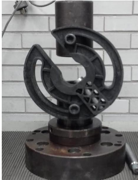
Figura 129 Análisis a tracción en la zona mixta.
