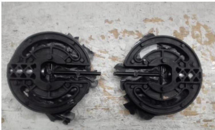
*Figura 123 Pieza con excedentes de material (rebabas).*
