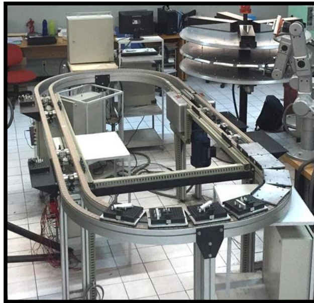
Figura 36. Banda transportadora, definida como entidad temporal para efectos de la simulación, cuya disposición tiene como finalidad que después de que la materia prima se encuentre sobre los templates contenidos en la banda, estos sean transportados hasta las entidades de los centros de maquinado, para que después de la finalización el proceso de manufactura, se adopte una estructura de almacén temporal o buffer en la curva previa al almacén rotatorio, con el objetivo de que al ser acumulados seis templates de manera consecutiva con productos procesados, estos sean reacomodados por el Robot #1 en el almacén rotatorio.
