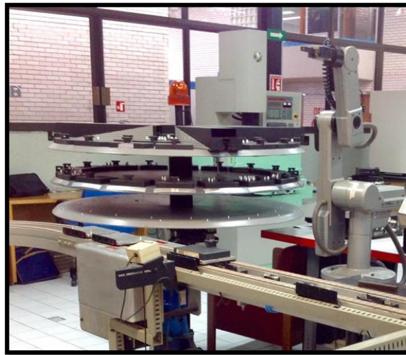
Figura 31. Robot Scorbot de 5 GDL, definido como Robot #1 para efectos de la simulación (Maq.1), cuya disposición es a un costado del almacén giratorio para el suministro de material de entrada y salida
