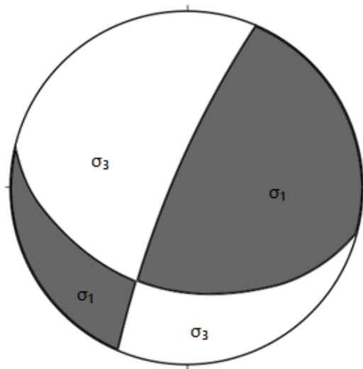
Ilustración IV.0.45 Análisis dinámico de una falla inversa en los datos tomados en Santo Tomás Otlaltepec.
