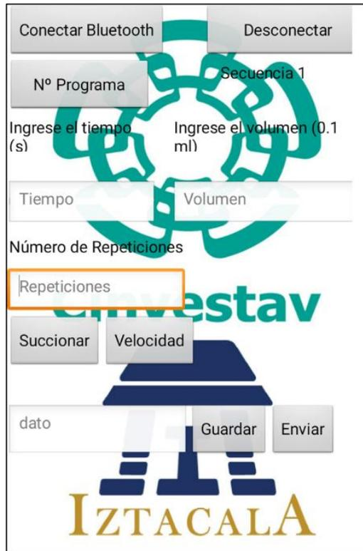
**Fig. 7. Controlador automático.** Aplicación permite controlar el sistema de flexión por medio de conexión bluetooth a un dispositivo electrónico. **Elaboración propia.**
