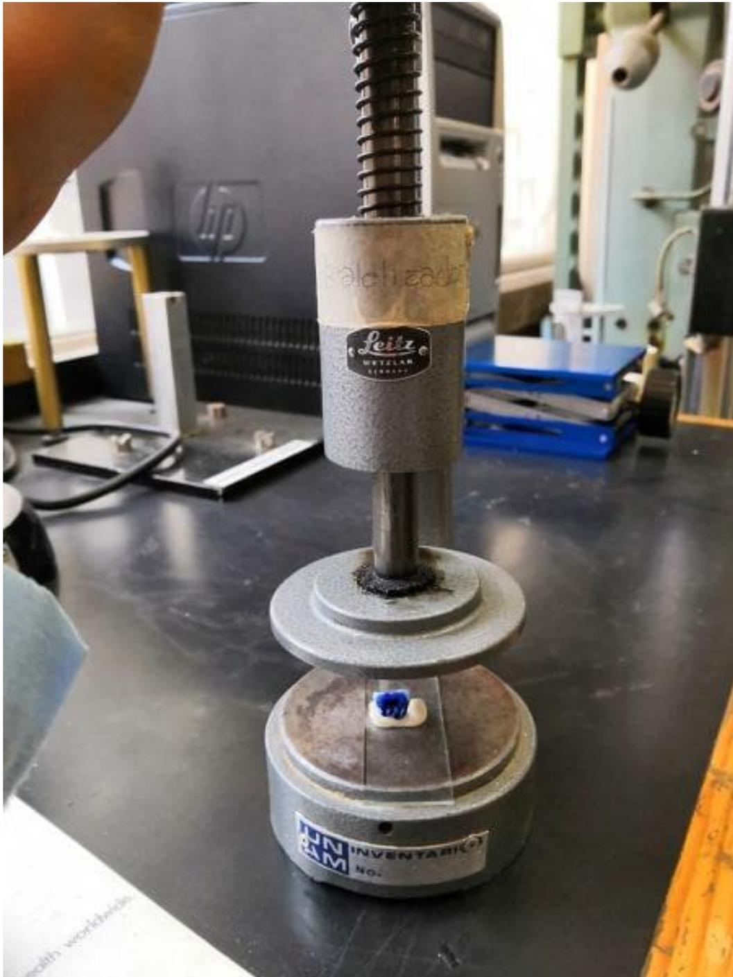
Figura 55. Paralelizador vista completa frontal
