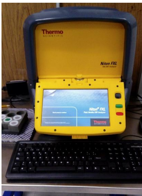
Figura 21 Difractómetro portátil NITON FXL 950 de la marca Thermo Scientific utilizado para el análisis de elementos mayores y trazas.
