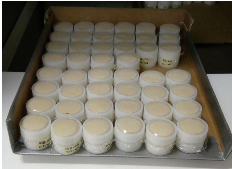
Figura 22 Muestras de la cuenca Sandia empaquetadas para el análisis de fluorescencia de rayos X.
