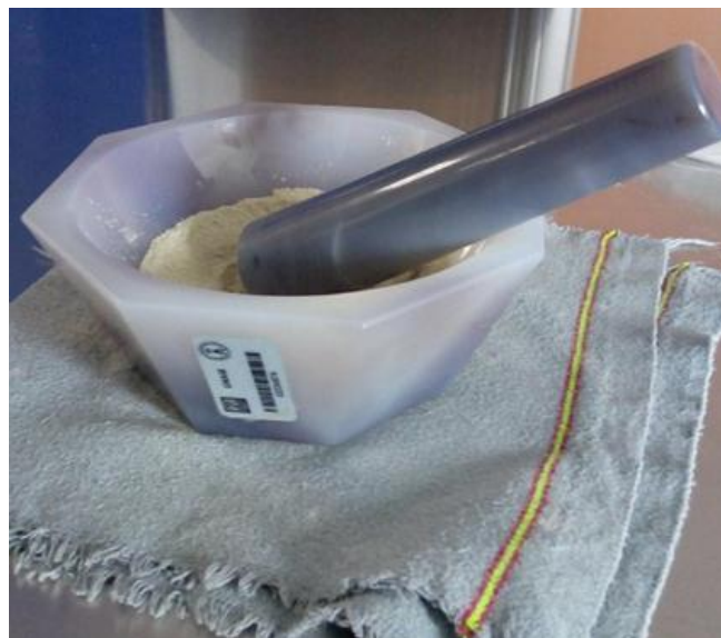
Figura 20 Mortero de ágata utilizado para moler las muestras obtenidas en la cuenca de Sandia.
