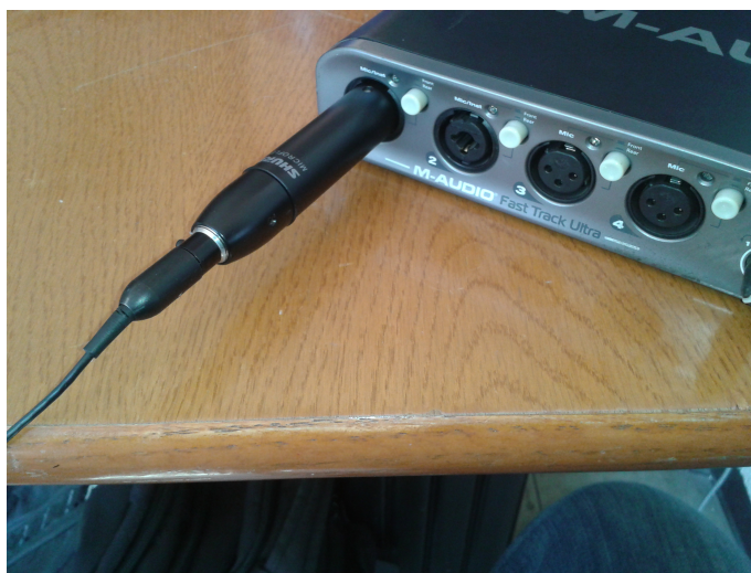
Figura 3.2: Conexión a canal 1.
