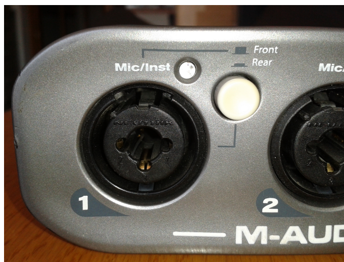
Figura 3.7: Botón para activación del canal frontal.
