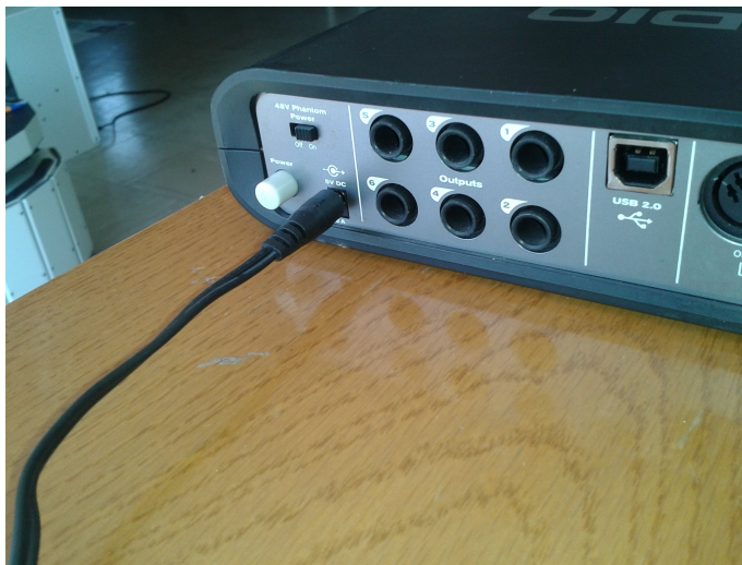
Figura 3.5: Conexión del eliminador a la interfaz de audio.
