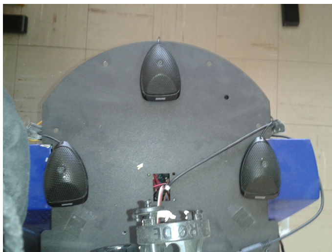
Figura 3.3: Topología de los micrófonos de superficie.
