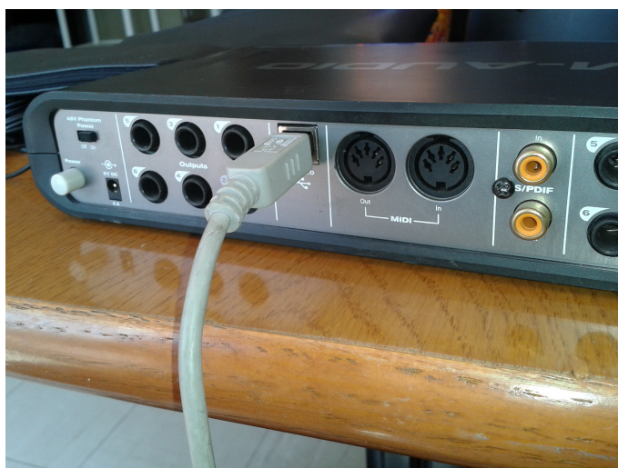
Figura 3.4: Conexión de cable USB a interfaz de audio.
