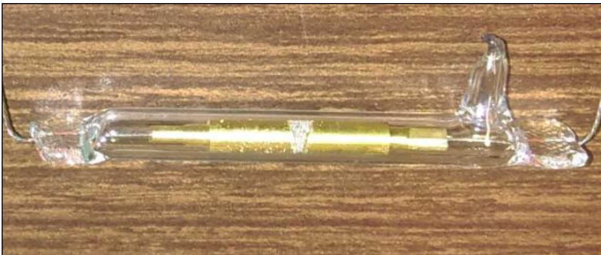
Figura 48: Memristor de tipo Marconi en posición horizontal invertida.
