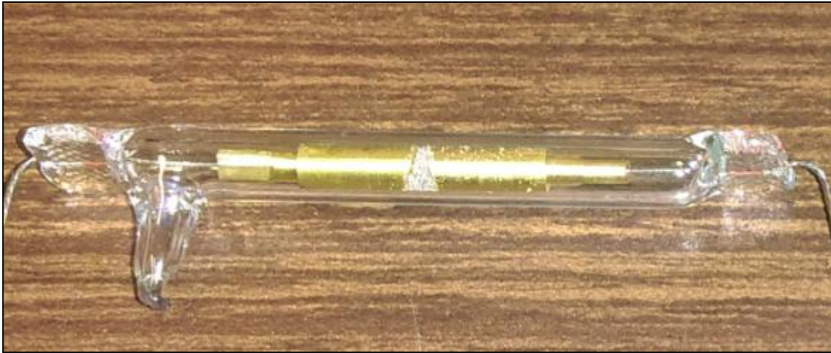
Figura 47: Memristor de tipo Marconi en posición horizontal.
