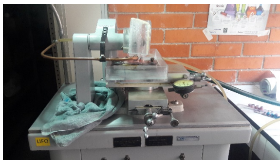
Imagen 32 Máquina de corte para las muestras. Fuente propia
