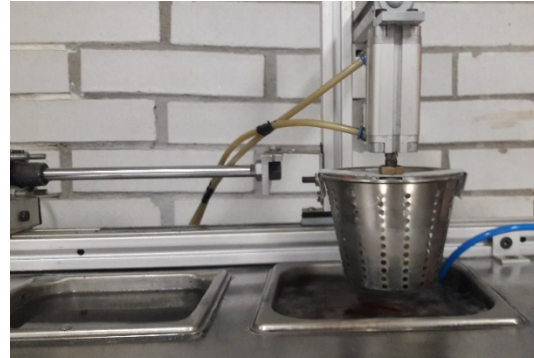
Imagen 21 Termociclado en 500 ciclos. Fuente propia
