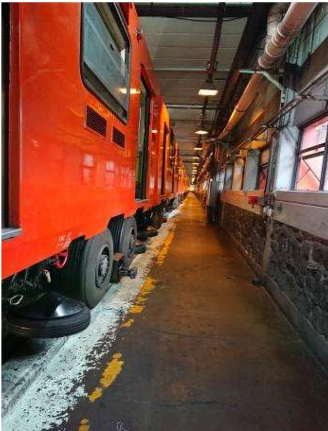
Figura 7. Los trenes son atendidos en una sola vía, verificando averías menores, niveles de aceite y presión normales, desgaste de piezas de fricción, etc.
