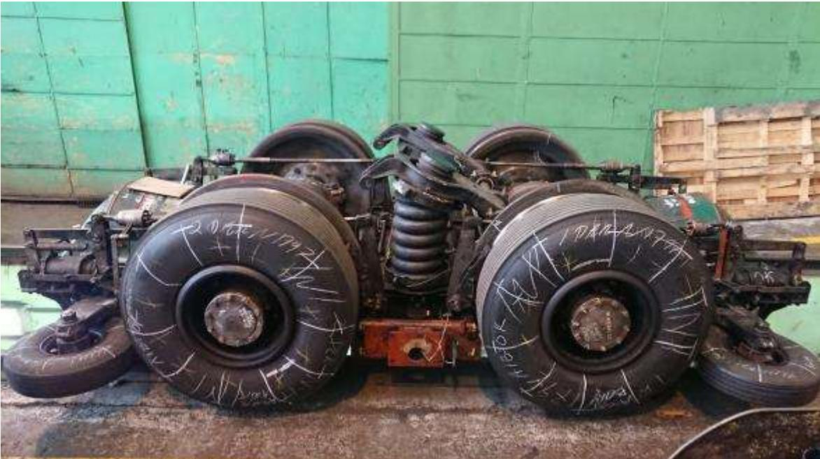
Figura 5. Bogie terminado por técnicos en mantenimiento de material rodante del taller de revisión general Zaragoza
