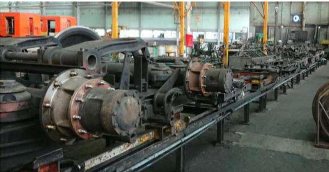
Figura 3. Los bogies son formados en la línea de desarmado hasta dejar el bastidor libre de órganos, procede al área de pruebas no destructivas.
