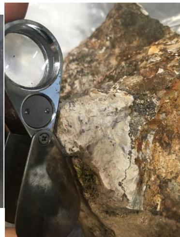
Fig.18. Muestra con mayor aumento de la roca. Se aprecia el bandeamiento (izquierda) y las esferulitas, pómez (derecha).
