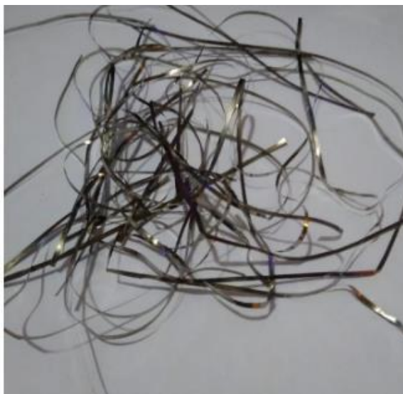
Figura 6.1 Cinta vítrea de Cu_{54.5}Hf_{45}Si_{0.5} obtenida por el método de fusión “Melt Spinning”
