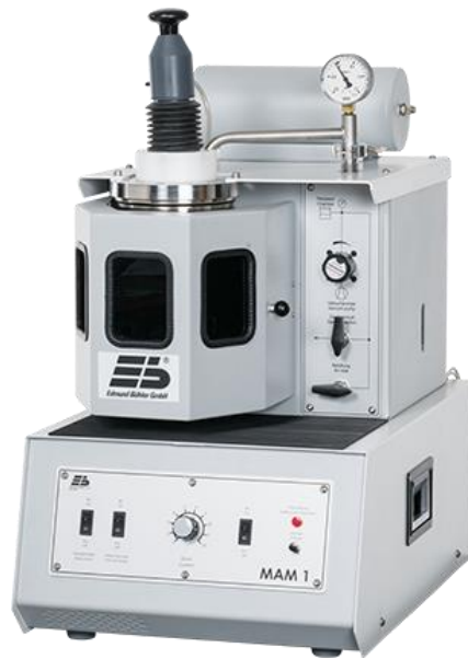
Figura 5.2 Horno de arco eléctrico MAM-1, marca Edmund Bühler.
