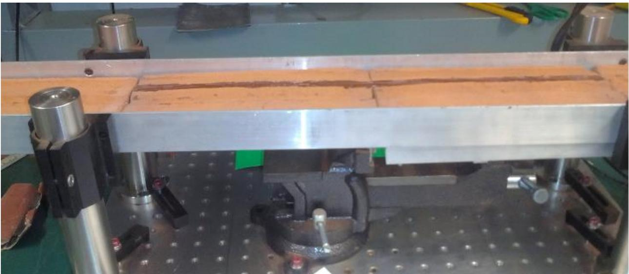
Figura 25: Experimento con la sujeción de la fibra óptica con el pegamento epóxico solo en dos tabiques – uno fijo y otro móvil (fotografía).
