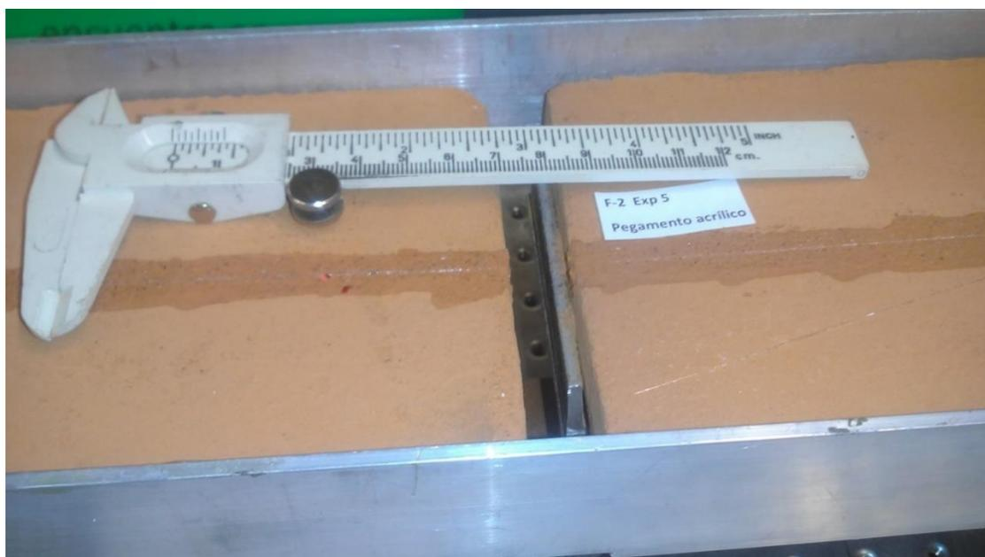
Se rompió la fibra óptica, con un desplazamiento ( $\Delta=9.25$  mm), se muestra como al romperse se despega la fibra del tabique.
