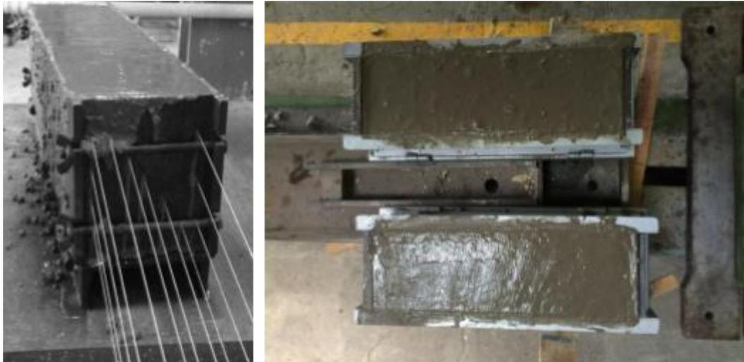
Figura 9: Elementos Estructurales con fibras ópticas embebidas [3].
