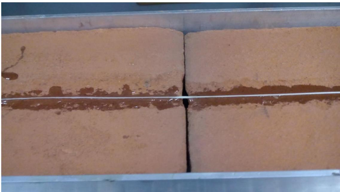
Figura 29: Experimento con fibra óptica jumper multimodo 62.5/125 sin recubrimiento externo (fotografía).
