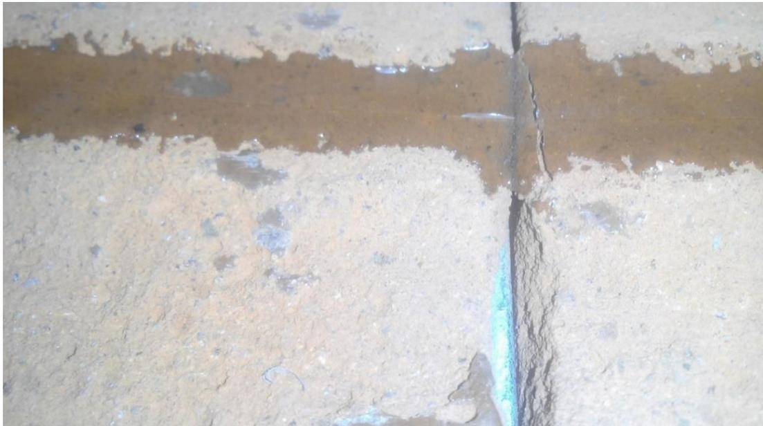
Se agrieta el pegamento a los  $\Delta = 2.11$  mm sin que se rompa la fibra ni se desplace dentro del pegamento.
