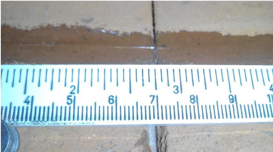
Se rompió el pegamento que unía los tabiques, pero la fibra no se rompe, el sensor de desplazamiento marcó  $\Delta = 2.38$  mm.
