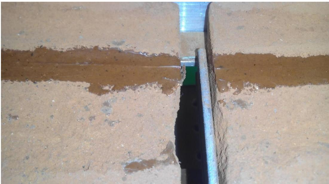
La fibra se rompe con  $\Delta = 3.54$  mm, se observa la fibra óptica no se desplazó dentro pegamento.
