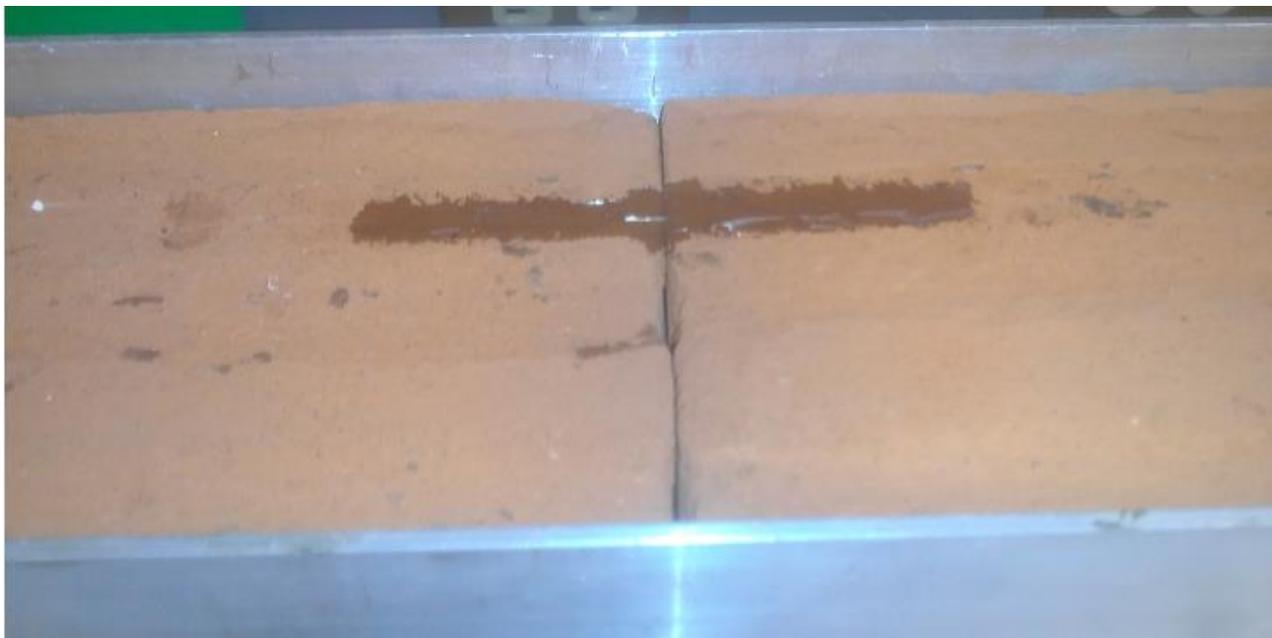
Figura 26: Experimento con la sujeción de la fibra óptica con el pegamento epóxico en una longitud de 45 mm solo en dos tabiques – uno fijo y otro móvil (fotografía).
