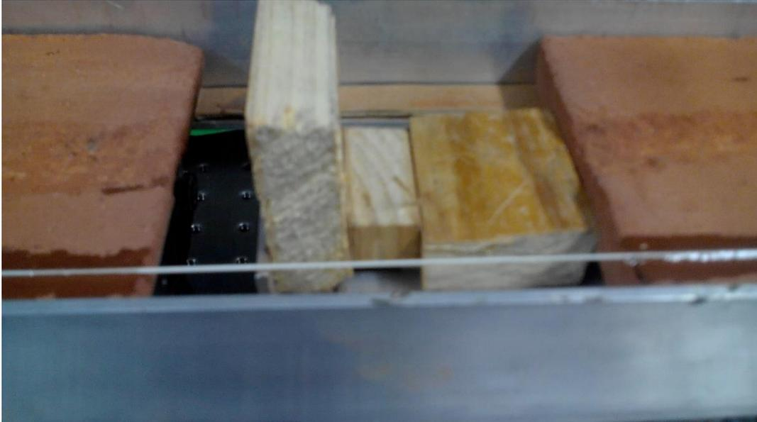
Se observa que si se desplaza la fibra en este caso hay una separación entre los tabiques de  $\Delta = 91.92$  mm
