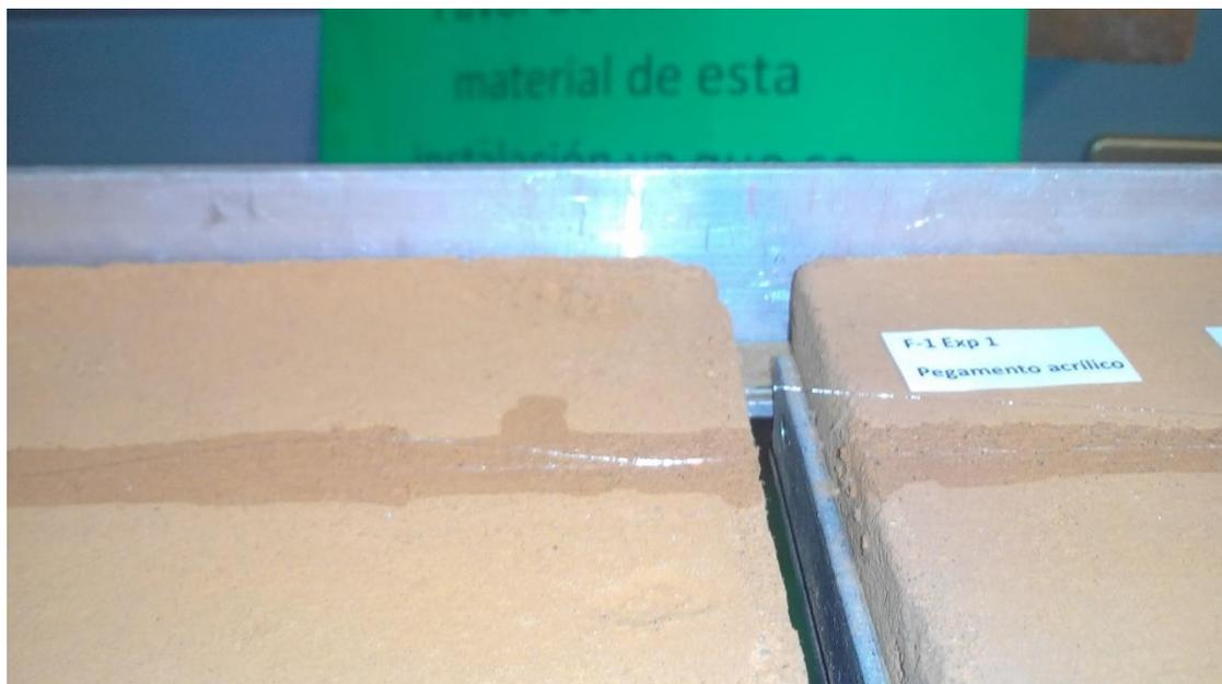
Se rompió la fibra óptica, el desplazamiento con que se rompió fue ( $\Delta=7.28$  mm), se muestra como al romperse se despega la fibra del tabique.
