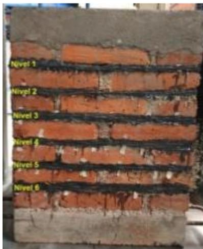
Figura 11: Pila de mampostería de tabique instrumentada con fibras ópticas [3].
