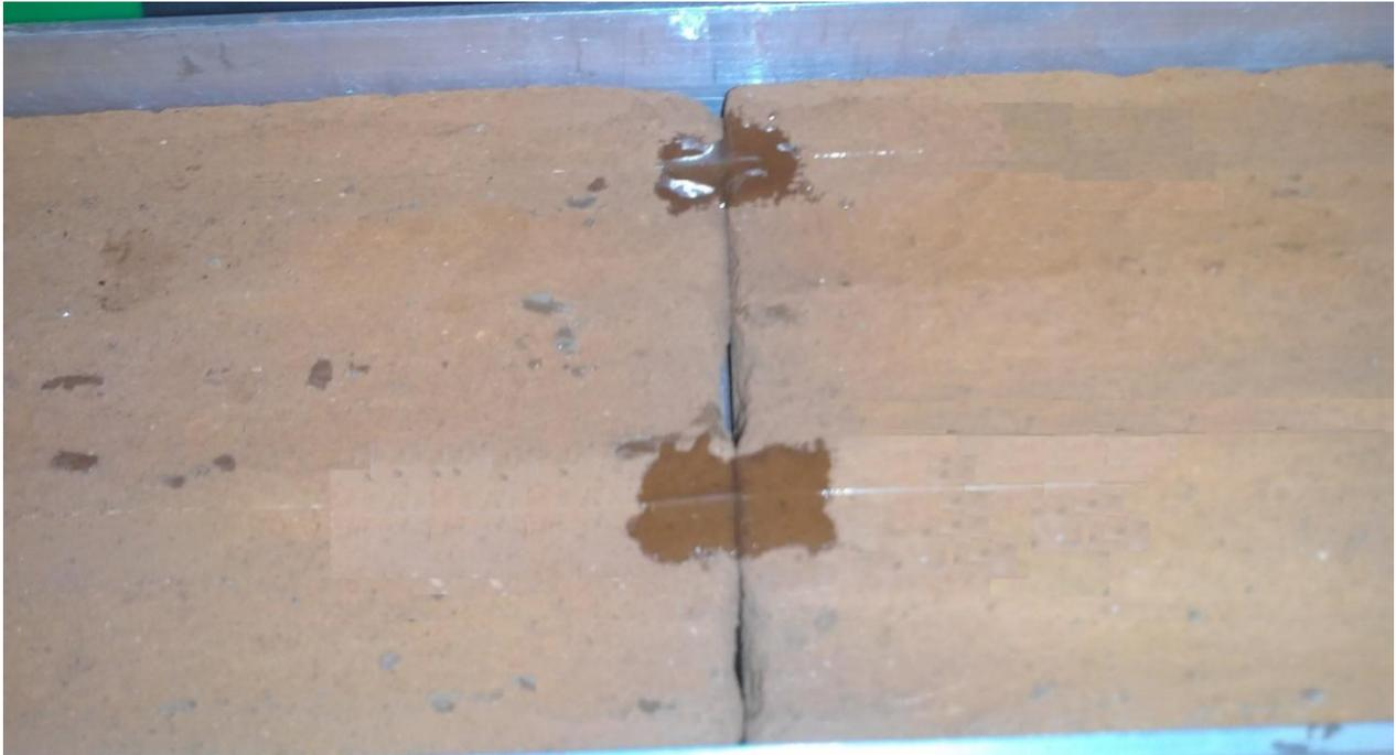
Figura 27: Experimento con la sujeción de la fibra óptica con el pegamento epóxico en una longitud de 10 mm en dos tabiques – uno fijo y otro móvil (fotografía).
