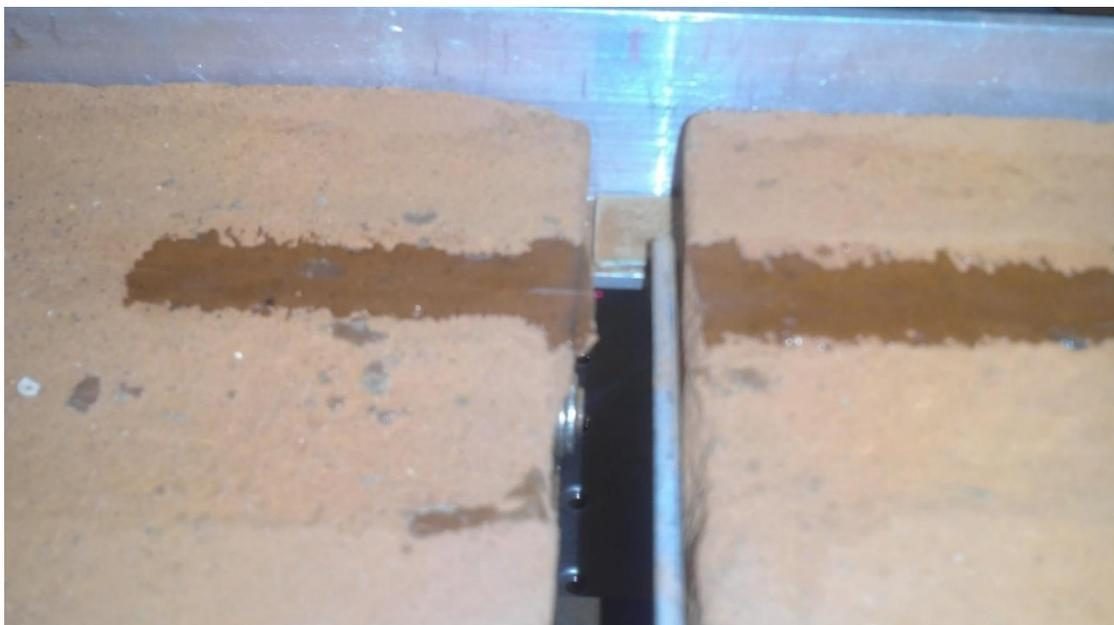
Se rompe la fibra a los  $\Delta = 4.74$  mm, sin que se desplace la fibra dentro del pegamento.
