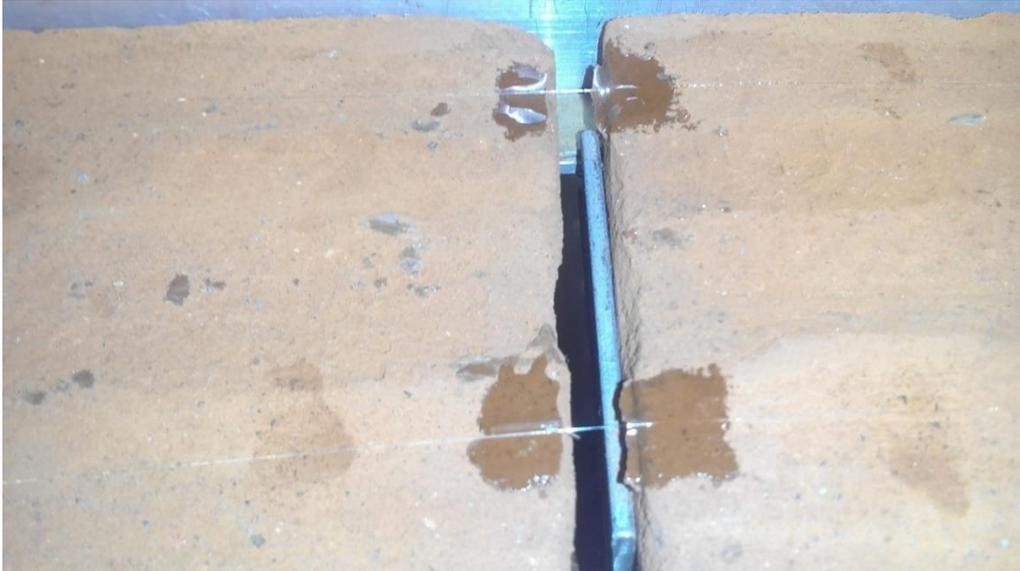
Al romperse el pegamento con un desplazamiento de  $\Delta=3.89$  mm, se desplazó la fibra se salió del pegamento y no se rompió.
