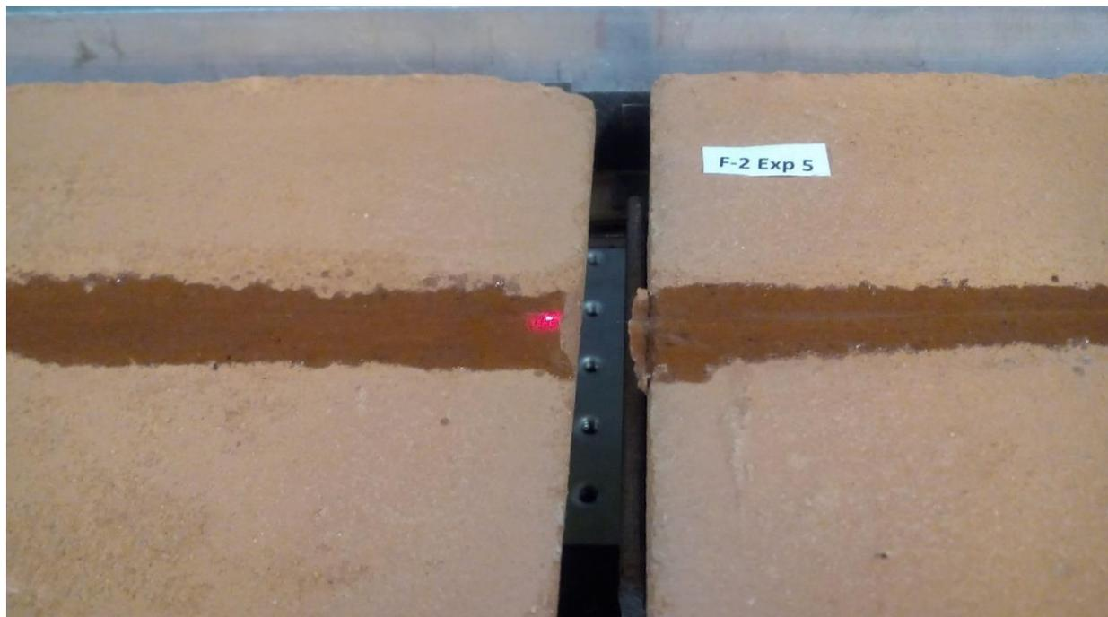
Se rompió la fibra óptica, se observa el rayo de luz saliendo de la fibra, el desplazamiento con que se rompió fue ( $\Delta=2.70$  mm).
