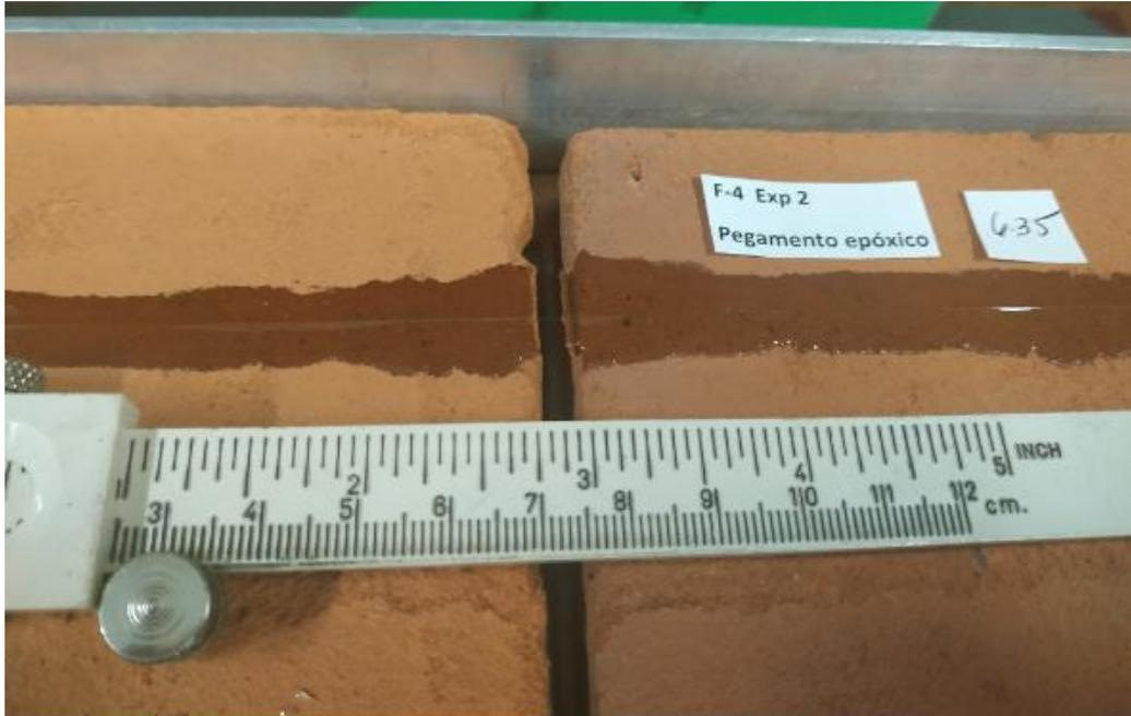
Se rompió el pegamento y se desplazaron los tabiques, se muestra una separación de los tabiques ( $\Delta=6.35$  mm).
