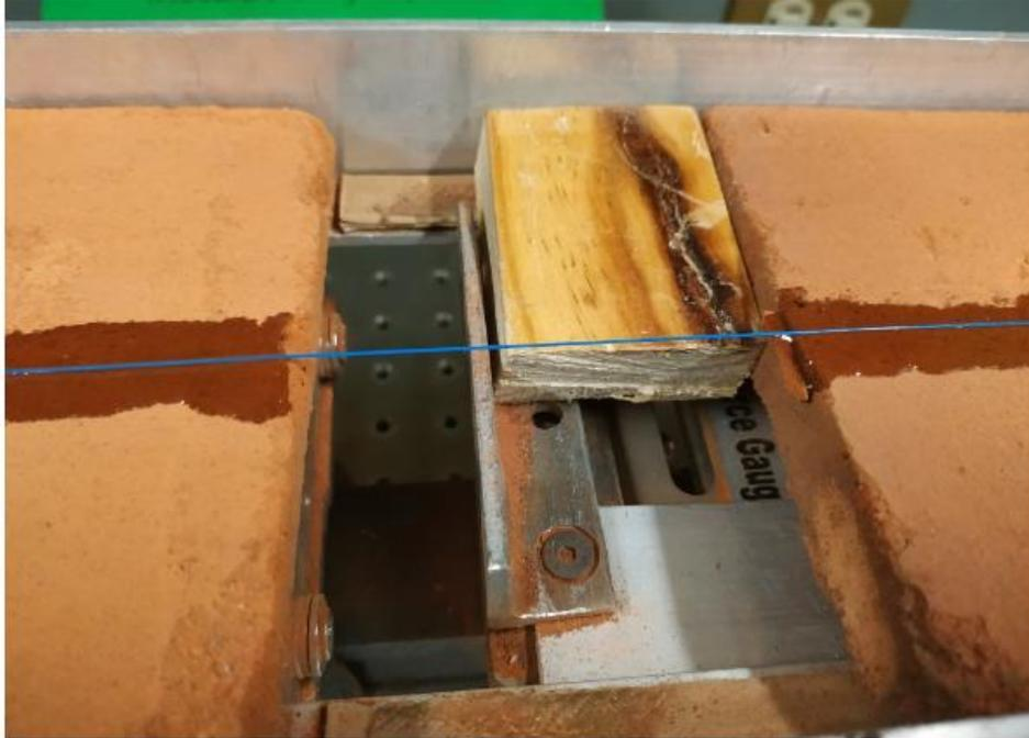
Se observa que si se desplaza la fibra en este caso hay una separación entre los tabiques de  $\Delta = 160.2$  mm.
