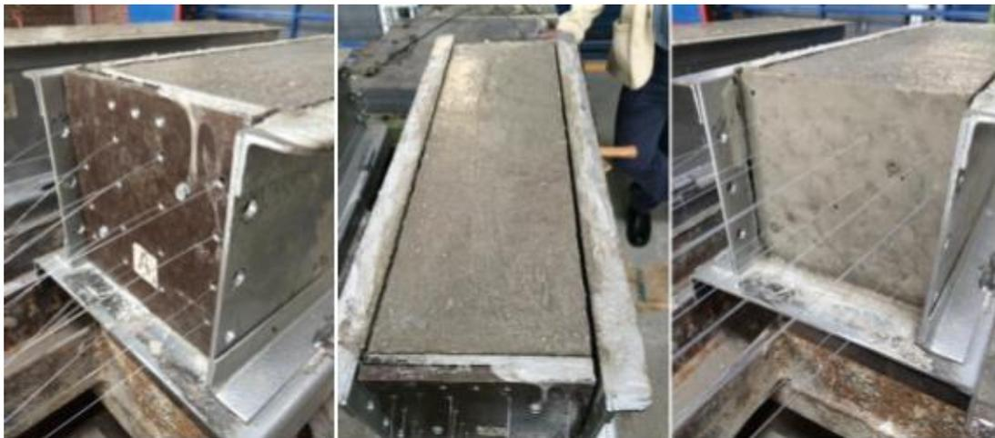
Figura 10: Secuencia del desmontaje del molde y placas laterales [3].
