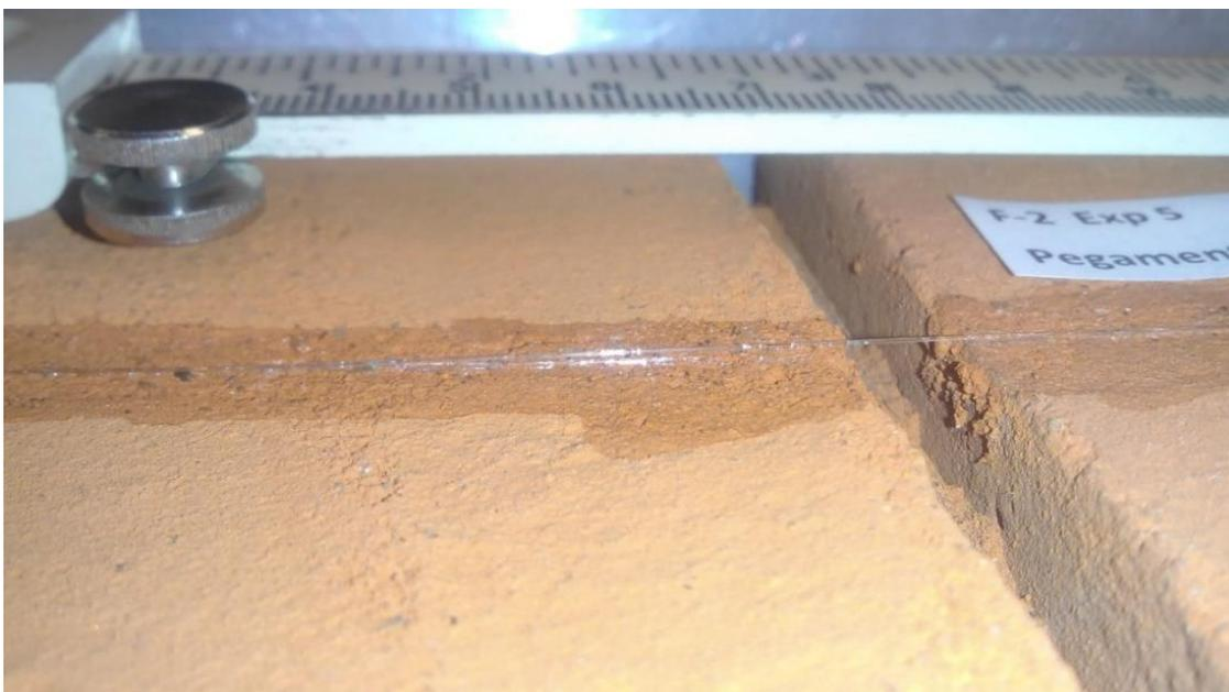
Se muestra una separación de los tabiques ( $\Delta=7.23$  mm), para la cual se observa que la fibra presenta ligeramente despegada del tabique.
