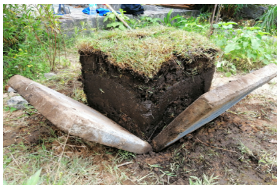
Apisonamiento del cubo con placas de concreto.
