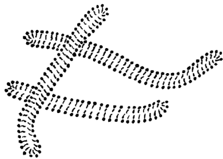
Figura 1.5 Ejemplo de fluido micelar de tipo gusano (Yang, 2002)
