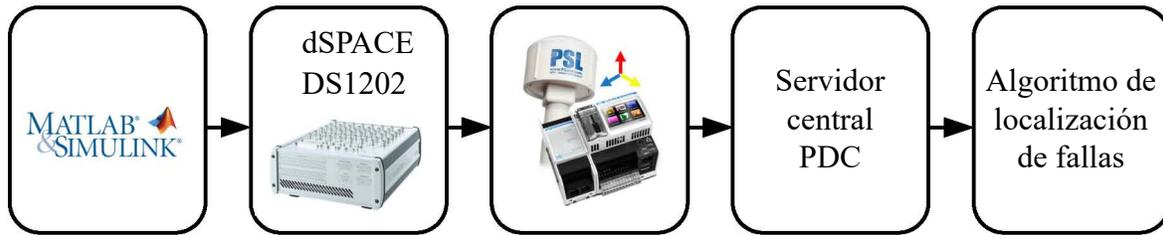
Figura 5.7: Esquema de la experimentación.
