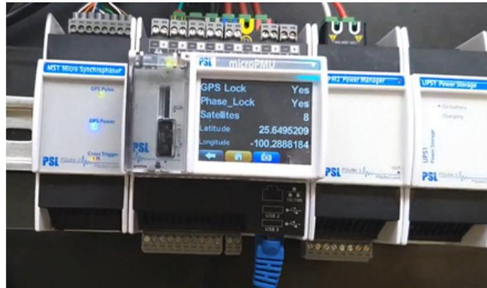
Figura 5.6: Micro-sincrofasor usado en la experimentación
