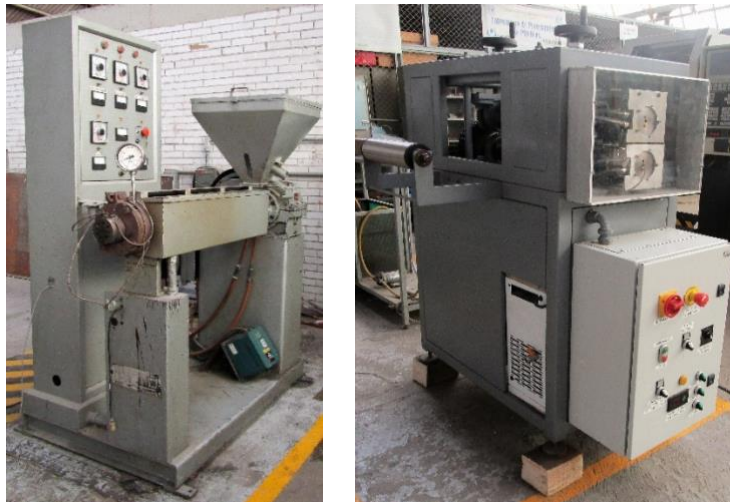
Ilustración 5. Máquina extrusora (izquierda) Jalador de películas de plástico (derecha) 1
