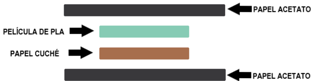
Ilustración 24. Arreglo para formar el material bicapa PLA papel
