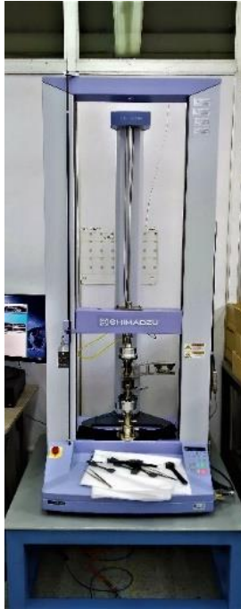
Ilustración 37. Equipo para pruebas mecánicas Shimadzu modelo: AGS-X 10kN
